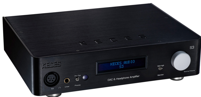
S3機箱以4mm鋁製成，面板同時擁有4Pin XLR與6.35mm耳機孔。顯示幕還採用OLED。旁邊的遙控接收窗代表S3擁有專用遙控器。
