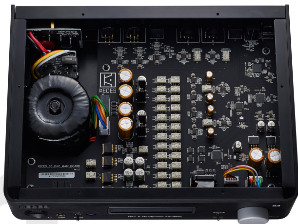
24顆繼電器陣列構成的音控是內部最注目的部分。內部配線極少，連端子也是直接與電路板相連；整齊的電路配置顯然是經過嚴謹規劃，是深思熟慮下的產品。
