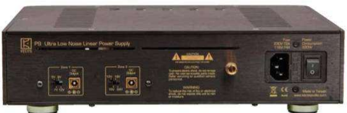
Zwei getrennte Ausgänge mit je vier schaltbaren Nennspannungen stehen zur Verfügung
